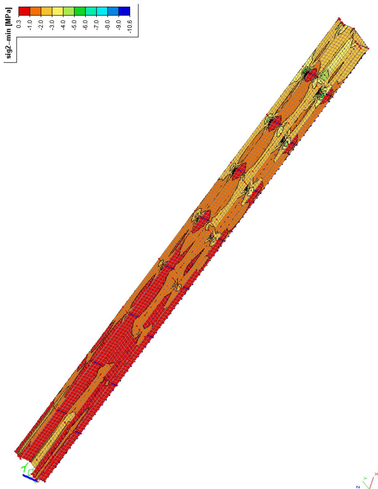
Obr. 61 – Hlavní napětí \sigma_2 - (kombinace zatěžovacích stavů C6B)
