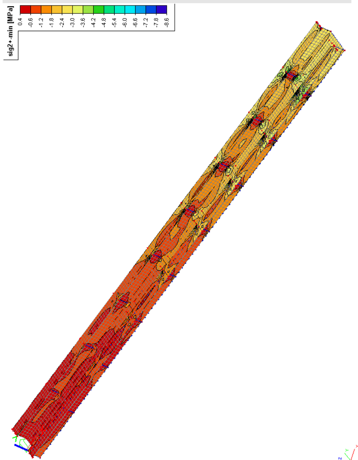
Obr. 53 – Hlavní napětí \sigma_{2+} (kombinace zatěžovacích stavů C2B)
